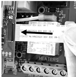
Figuur 2 Plaats het losse relais- en sensorbord op het moederbord
